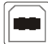
Рисунок 3.7 4-контактный USB разъем типа B
