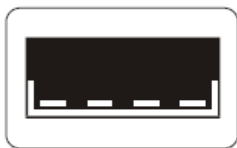
Рисунок 3.6 4-контактный USB разъем типа A
